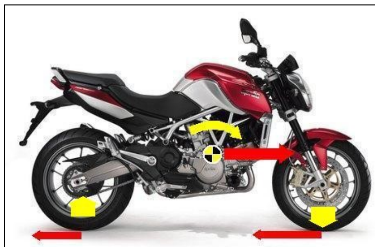
Figura 51 - Trasferimento di carico in frenata
