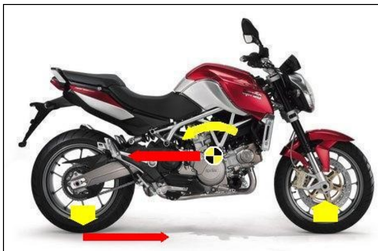
Figura 49 - Trasferimento di carico in accelerazione
