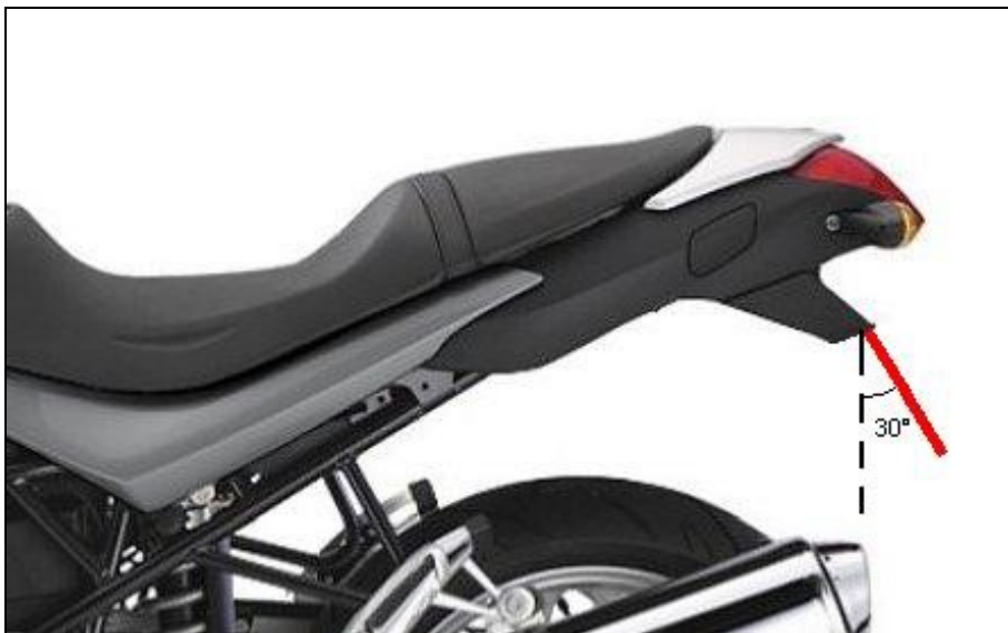
Figura 127 –Inclinazione massima della targa
