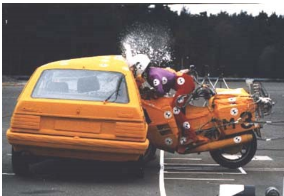
Figura 1 – Crash test di una moto contro un'auto
